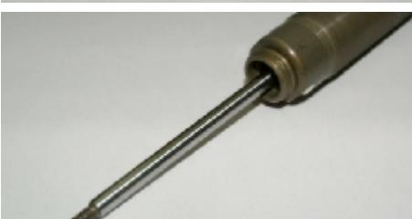
Führen Sie die Kolbenstange mit Dämpferkolben in das Dämpfergehäuse ein.
