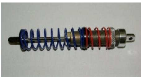
Montieren Sie die Hauptfeder und den Federteller.
