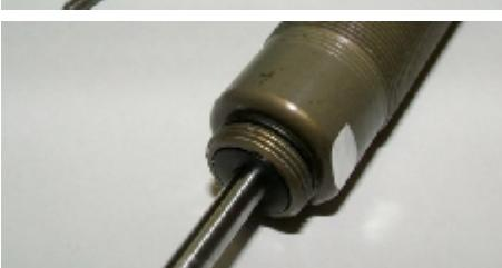
Schieben Sie den Wellendichtring über die Kolbenstange. Die geschlossene Seite zeigt zur Unterseite. Führen Sie den Ring in die untere Öffnung des Gehäuses. Montieren Sie den kleinen O-Ring auf das Dämpfergehäuse (gewindeseitig).
