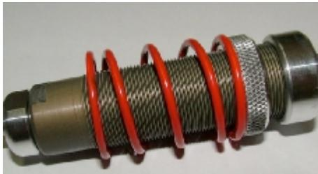
Montieren Sie bei den langen Dämpfern die Tenderfeder (kurz).
