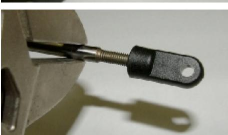
Montieren Sie den unteren Dämpferhalter.
