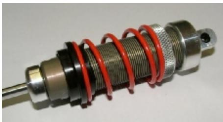
Führen Sie den Führungsring auf das Dämpfergehäuse.
