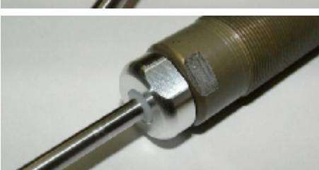
Schrauben Sie den unteren Verschluss auf die Unterseite des Gehäuses.
