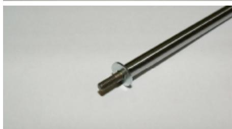
Stecken Sie nun den Dämpferkolben gefolgt von einer weiteren U-Scheibe auf die Kolbenstange.
