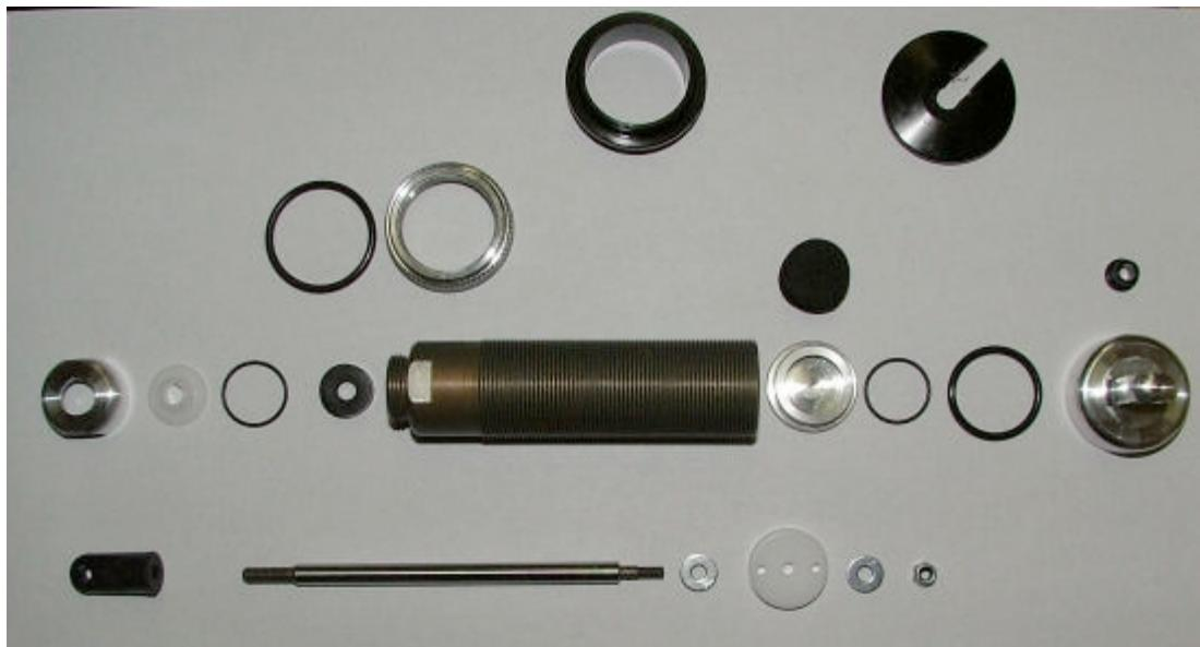
Legen Sie die Führungsbuchse in den unteren Dämpferverschluss.
