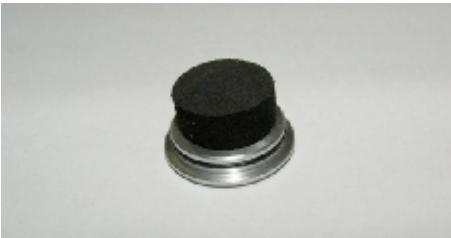
Entfernen Sie den Klebeschutz von dem Volumenausgleich. Montieren Sie den O-Ring um den Druckdeckel und setzen den Volumenausgleich ein..
