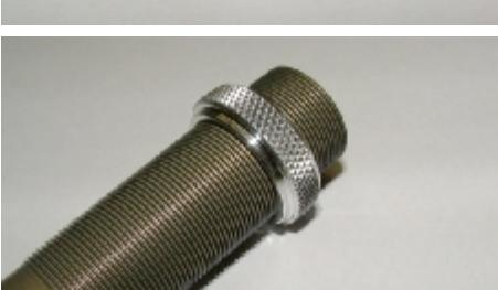
Schrauben Sie den Verstellring auf das Dämpfergehäuse.
