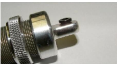
Setzen Sie die Führungsbuchse in den Verschlussdeckel ein und pressen sie bündig.
