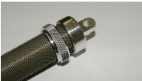
Schrauben Sie den oberen Verschlußdeckel auf das Gehäuse. Die Führung für Feder zeigt zur Unterseite.
